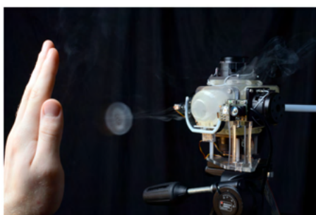
Figura 15: O dispositivo AIREAL emite um anel de ar chamado vórtice, que transmite forças físicas que um utilizador pode sentir ao ar livre.
