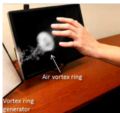
Figura 13: O protótipo AirWave emite um vórtice de fumo para provar a estimulação háptica de não-contacto.
