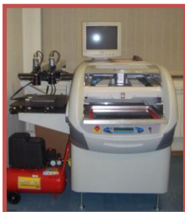
Fig. 14 - Equipamento de serigrafia DEK 248 (DEK, Reino Unido).
