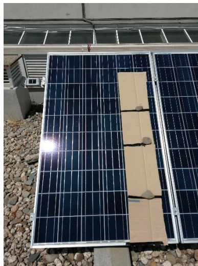
Figura 2.15 - Fotografia do módulo PV com sombreamento parcial simulado.
