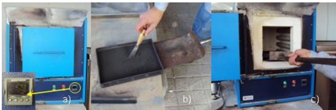
Fig. 4.4- a) Monitor para a configuração da temperatura; b) Finos de Lamas prontas a calcinarem; c) introdução das lamas na mufla.
