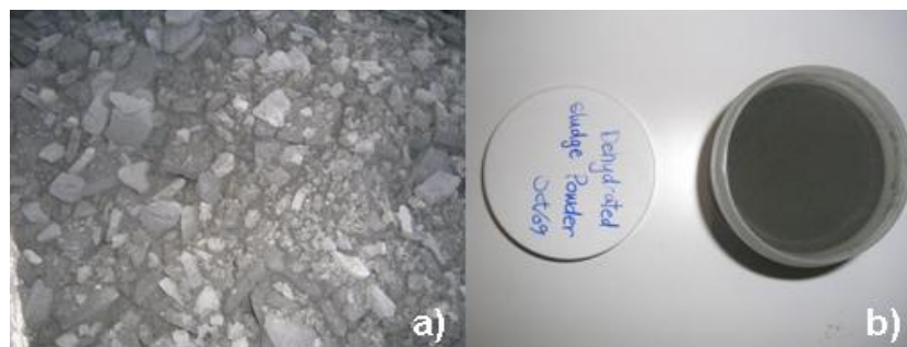
Fig. 2.4. a) Amostra das lamas no estado bruto; b) aspeto final das lamas secas e moídas.
