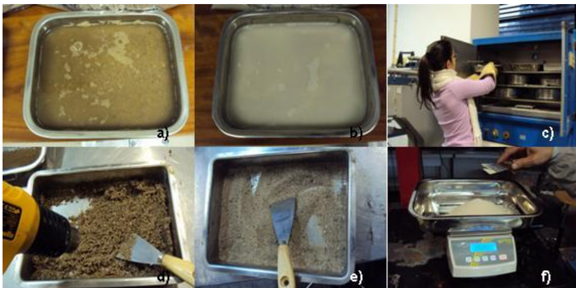
Fig. 4.11- Determinação da absorção de água dos agregados finos
