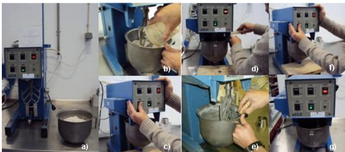
Fig. 4.19. Procedimento de amassadura das argamassas.
