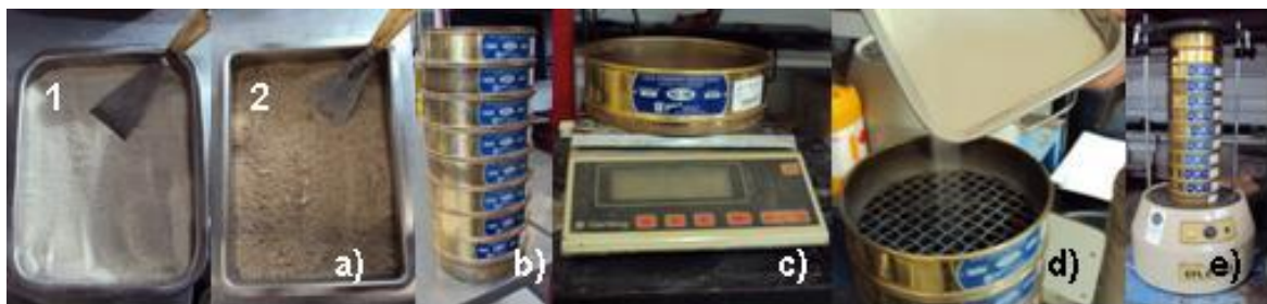
Fig. 4.12- a.1) Amostra da areia 02 seca; a.2) Amostra da areia 04 seca; b) Peneiros colocados pela ordem de normalização; c) Medição dos peneiros através de uma balança de alta precisão; d) Inserção da areia nos peneiros; e) Agitadora de peneiros
