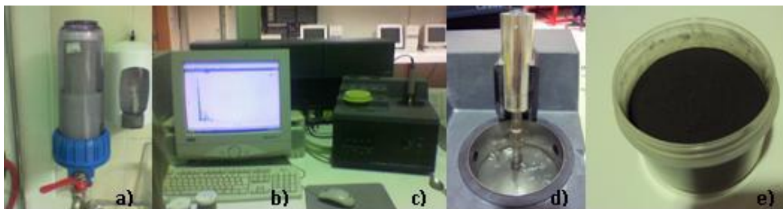
Fig. 4.15. a) Filtro de água; b) Software de análise de difração a laser; c) Analisador LS COULTER 200; d) Local de introdução da amostra; e) Amostra para análise.
