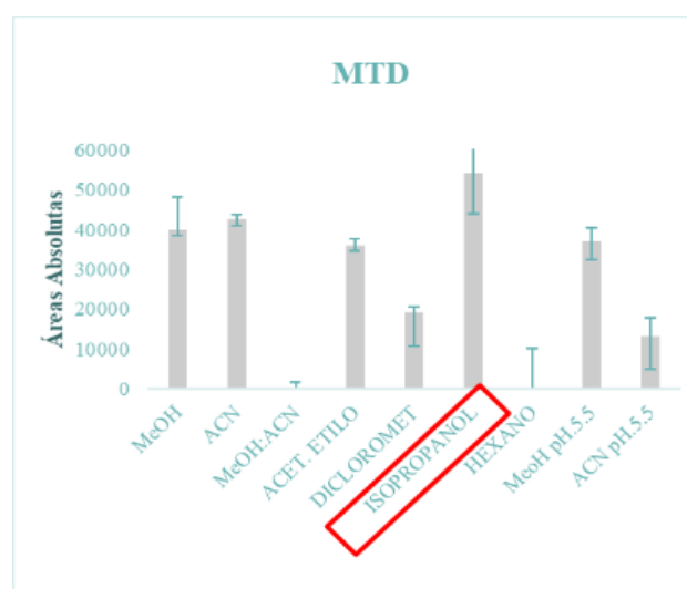
Figura 9: Representação gráfica as áreas absolutas obtidas para EDDP (à esquerda) e para a MTD (à direita) após extração com diferentes solventes.
