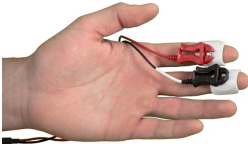
Imagem 8: O sensor da atividade eletrodérmica (EDA). Fonte: Dworak W. S. (2020, p. 27)
