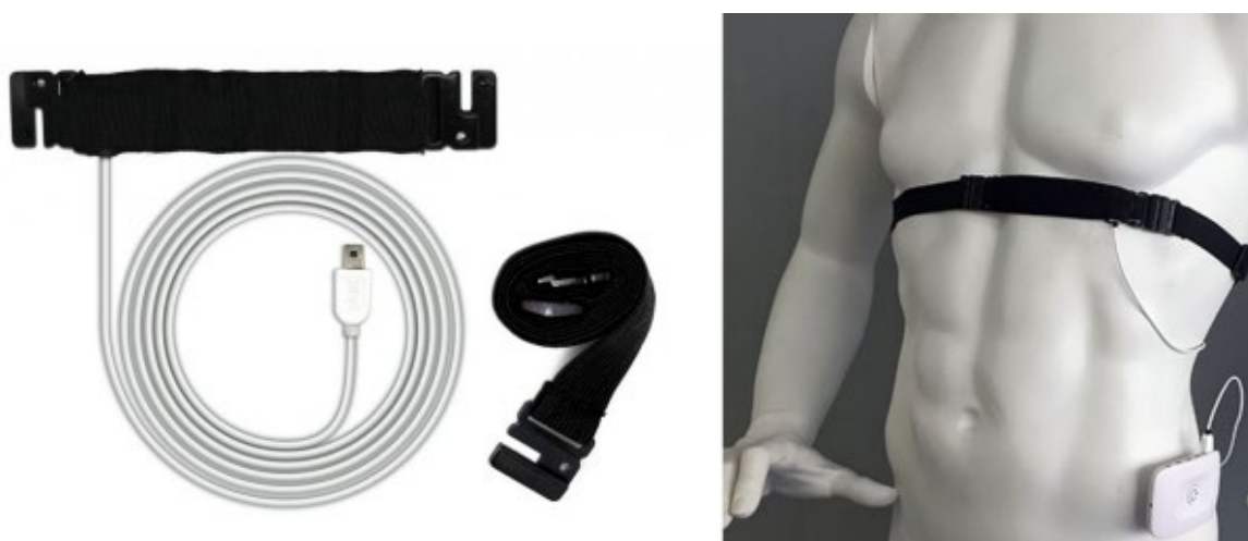
Imagem 9: O sensor de dilatação plexo dorsal (RESP). Fonte: Dworak W. S. (2020, p. 24)
