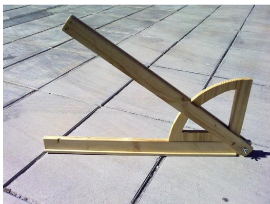
Figura 18 Compassos astronómicos artesanais usados para medir ângulos. Nas figuras, encontram-se a ser usados na medição de alturas
