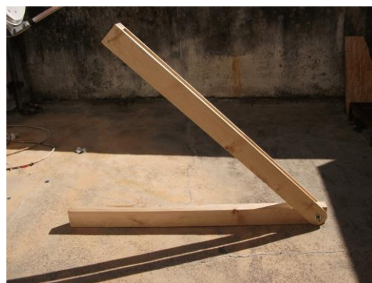
Figura 18 Compassos astronómicos artesanais usados para medir ângulos. Nas figuras, encontram-se a ser usados na medição de alturas
