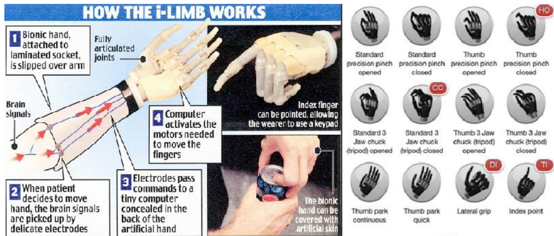
Figura 2.2 - Componentes da mão próstética i-Limb Ultra, da Touch Bionics [30]
