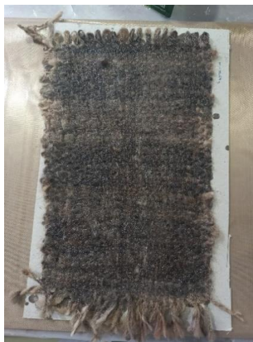
Figura 34: Tecido plano produzido com o fio de lã de pêlo de cão embebido pela matriz
