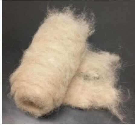
Figura 29: Fibras da lã de cão após a cardação
