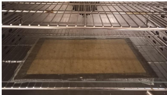
Figura 36: Pós-cura do compósito
