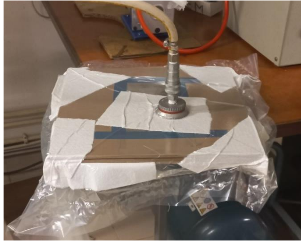
Figura 35: Compósito sob vácuo
