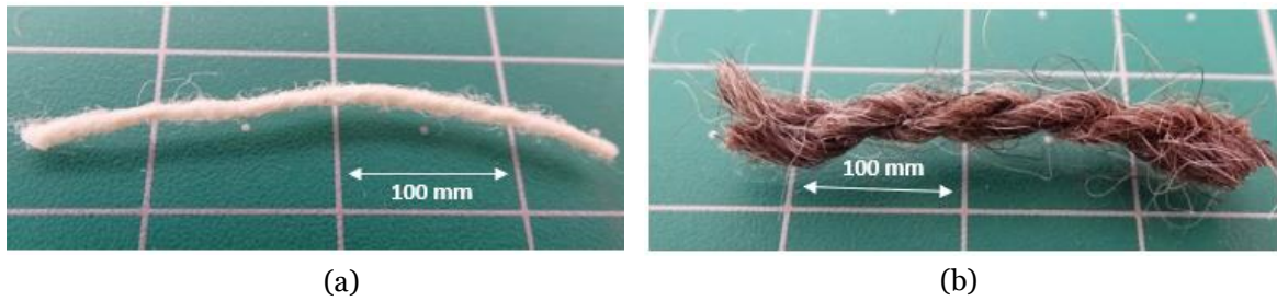
Figura 27: Fios das fibras usadas no reforço – (a) fio de lã de ovelha; (b) fio de lã de pêlo de cão
