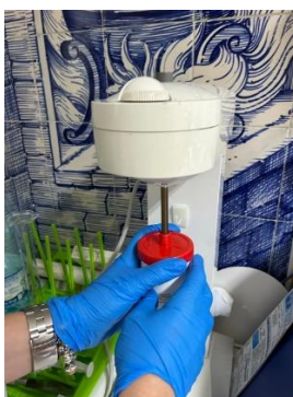
Figura 38: Utilização do aparelho unguator de forma a homogeneizar os constituintes da pomada
