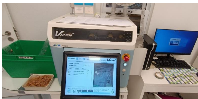
Figura 12: Máquina que fotografa as saquetas de PIM.
