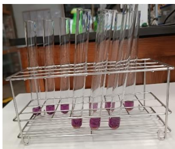
Figura 5: Tubos de ensaio com os filmes e a solução de DPPH (0,1 mM em metanol).
