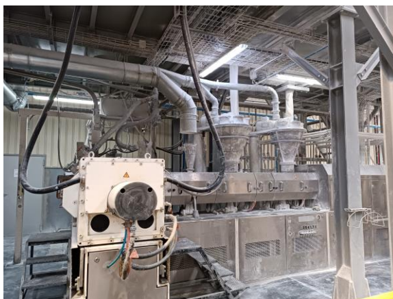
Figura 2: Extrusora utilizada no processo produtivo de referências da família dos compostos de PE e PP.
