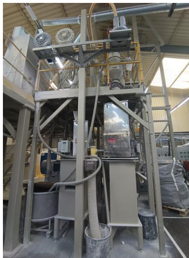
Figura 1: Dosificador gravimétrico utilizado no processo produtivo de referências da família dos compostos de PE e PP.
