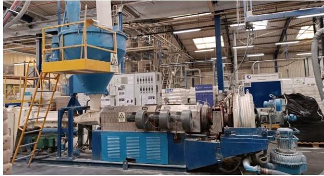
Figura 3: Extrusora utilizada no processo produtivo de referências da família dos compostos de PVC.
