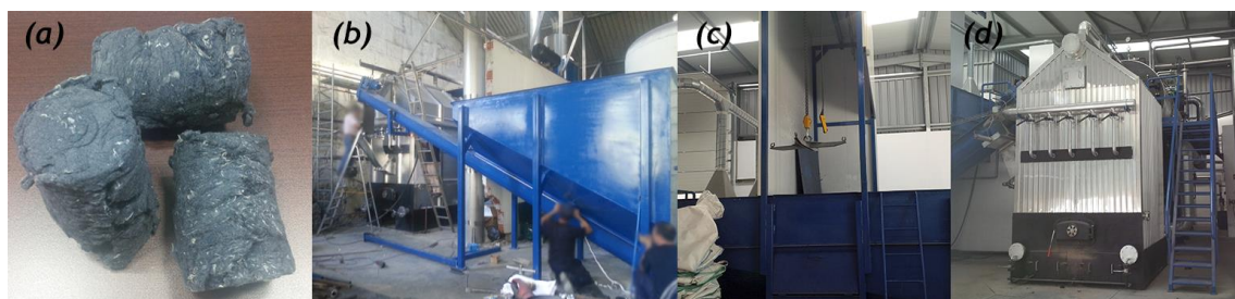
Figura 4.2 - (a) Briquetes de resíduos têxteis compostos 90% algodão e 10% poliéster; (b) caldeira a vapor que usa pellets de madeira como combustível utilizado no estudo; (c) silo do sistema de alimentação do forno; (d) forno de caldeira a vapor [4].
