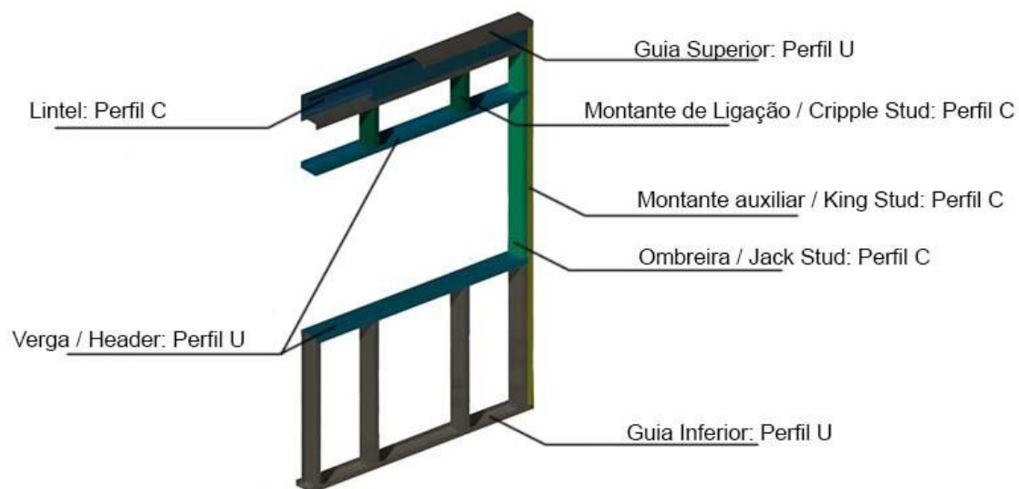
Figura 28 - Abertura de janela em parede
