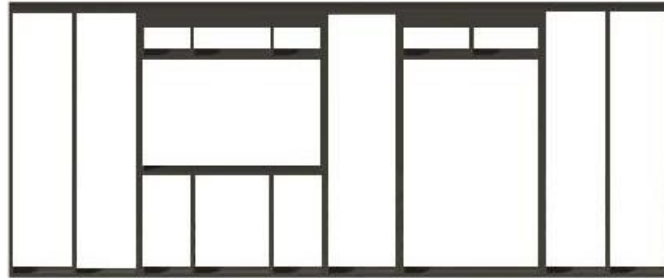
Figura 27 - Aberturas no sistema LSF
