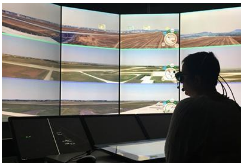
Figura 2.13: Imagem de um controlador de tráfego aéreo a controlar 3 aeroportos ao mesmo tempo [42]
