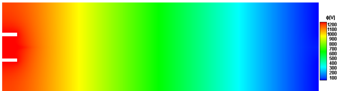
Figura 4.24: Contornos do potencial elétrico ( t=15\mu s ).
