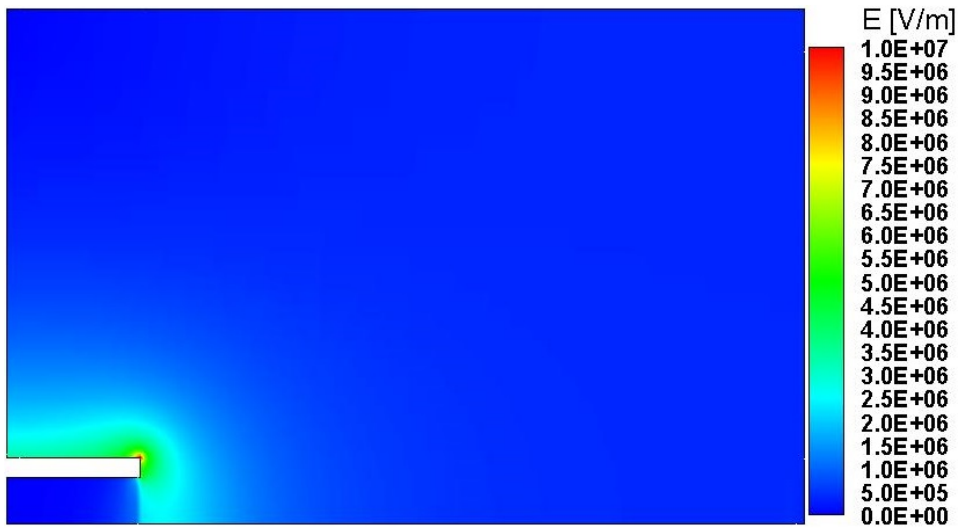
Figura 4.14: Contornos do campo elétrico inicial obtido no cálculo (t=0ms).
