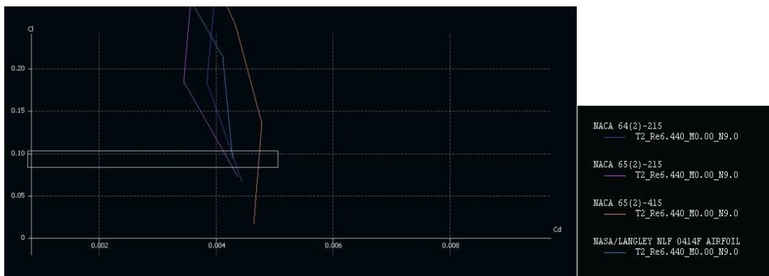
Figura 11: Polar de arrasto (aproximação da zona de CL=0,09) de quatro perfis estudados
