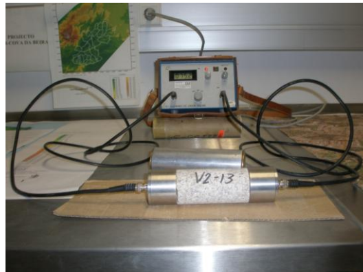
Figura 3.17 - Medição da velocidade de propagação de ultra-sons, com equipamento PUNDIT [14] .
