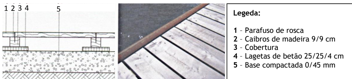
Imagem 118 - Pavimento de madeira anti-derrapante
