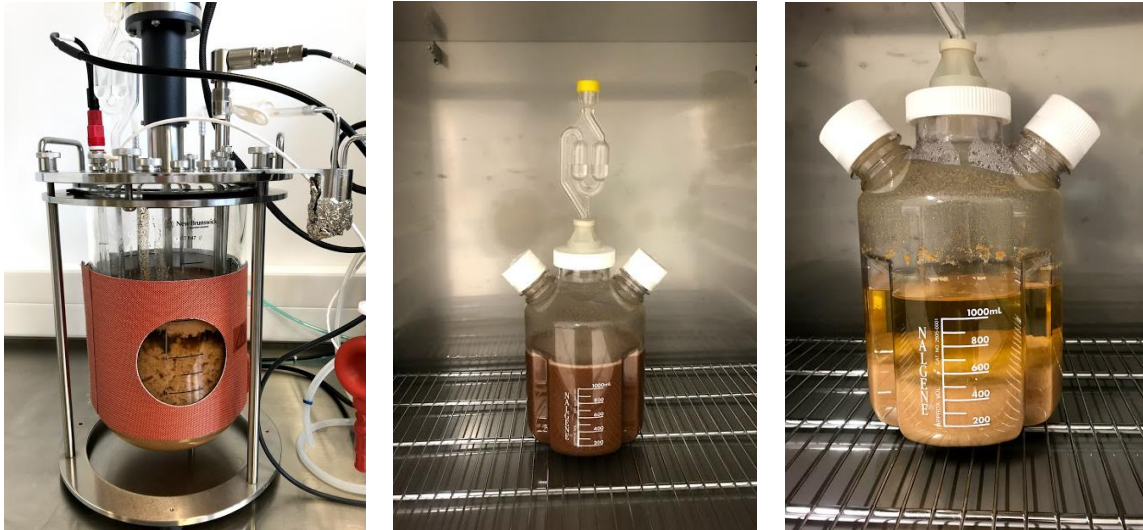
Figura 16. À esquerda o fermentador de laboratório, ao meio e à direita o depósito de plástico, no início e no fim da fermentação alcoólica, respetivamente.
