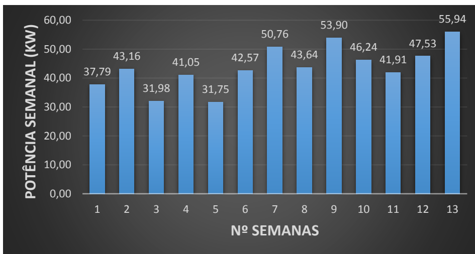
Figura 4.37 - Acumulados semanais de potência para o GLRVC planar (Costa da Galé - Verão)
