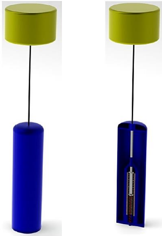
Figura 3.16 - Desenho de conjunto do sistema de geração tubular [21]
