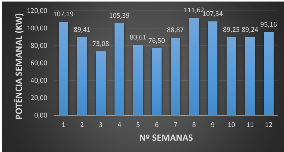
Figura 4.25 - Acumulados semanais de potência para o GLRVC planar (Baía Cascais - Inverno)
