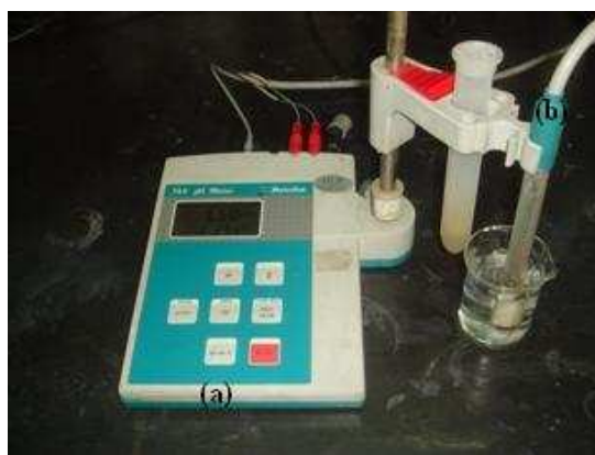
Fig. 5.2 – Medidor de pH, Metrohm, modelo 744 (a) e eléctrodo, Metrohm, ref a 0.0228.000 (b) .
