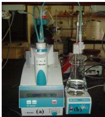
Fig. 5.6 – Titulador automático, Metrohm, 775 (a) e agitador magnético, Metrohm, 728 (b) .
