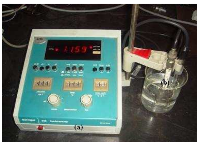
Fig. 5.4 - Condutivímetro, Metrohm, modelo 660 (a) e célula, Metrohm, ref a 6.0901.110 (b)
