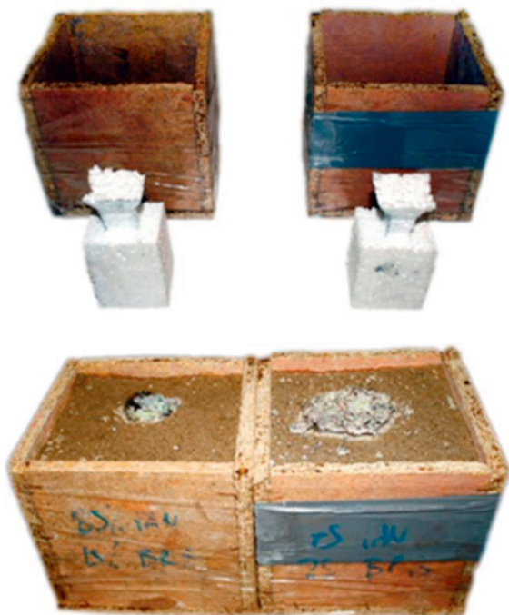
Fig. 6. Caixas de moldação, com areia de agregado fino da Panasqueira antes e após a fundição de bronze.
