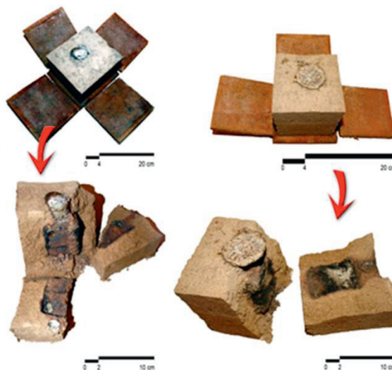
Fig. 7. Abertura do molde refratário e obtenção das peças de bronze.
