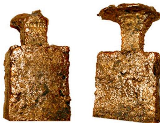
Fig. 7. Abertura do molde refratário e obtenção das peças de bronze.
