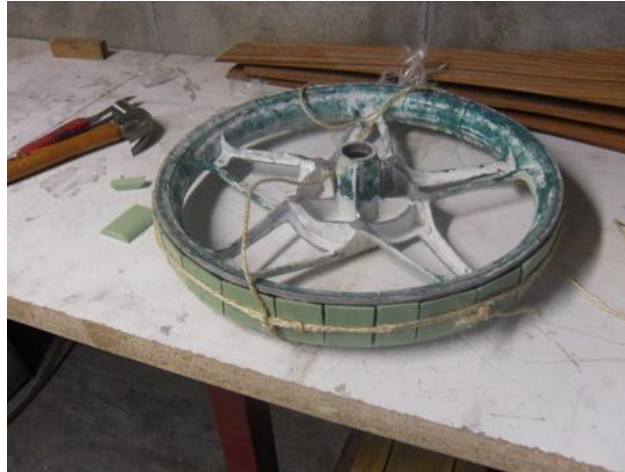
Figura 8.6 - Roda usada para molde do aro
