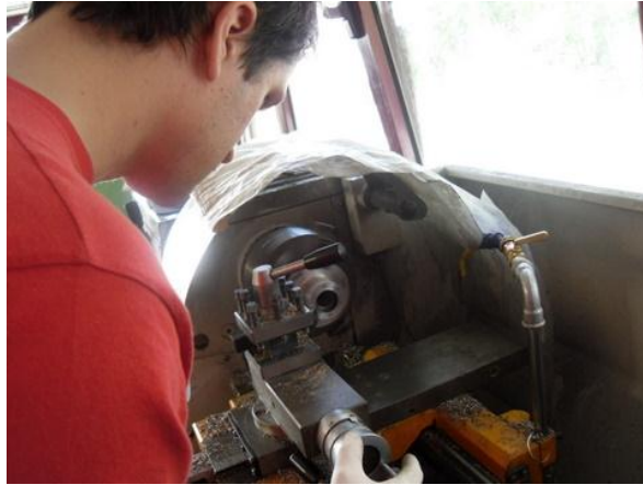
Figura 8.2 - Maquinagem do cubo no torno
