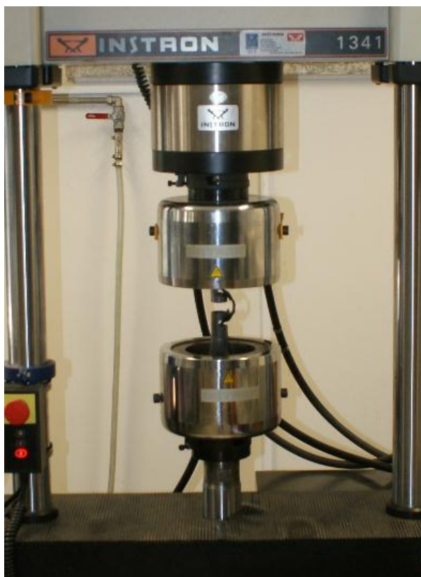
Figura 7.3 - INSTRON 8800 no ensaio de tracção
