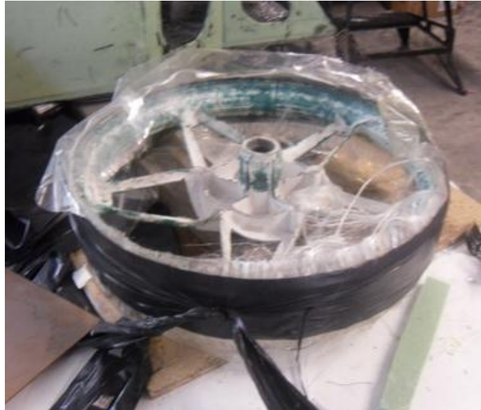
Figura 8.7 - Apoio de plásticos exteriores no molde
