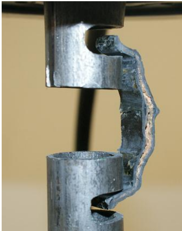
Figura 7.5 - Ruptura de provete em ensaio
