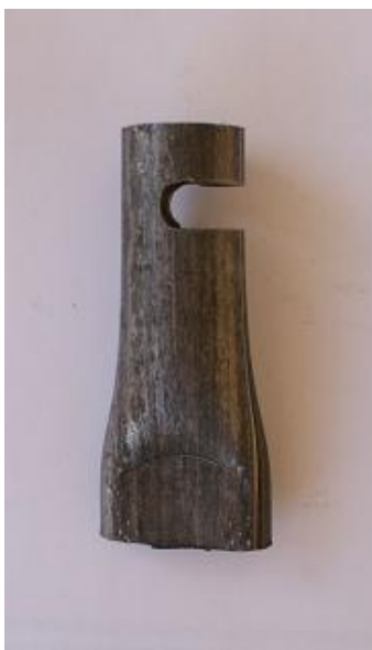
Figura 7.2 - Suporte para ensaio de tracção
