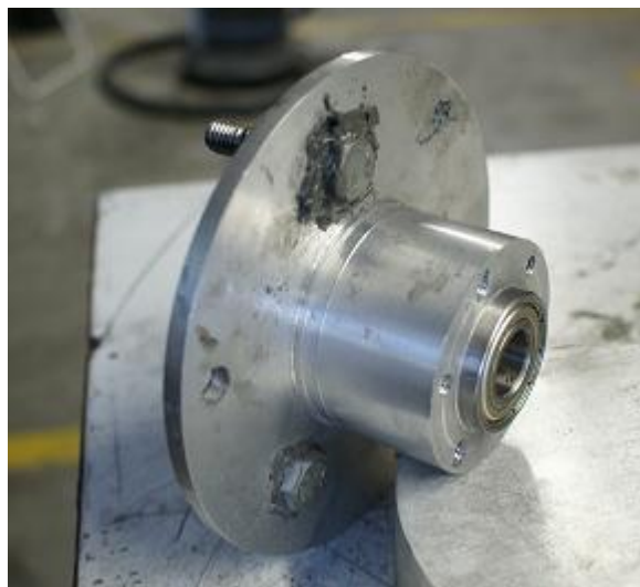
Figura 8.5 - Pormenor da araldite nos parafusos do cubo
