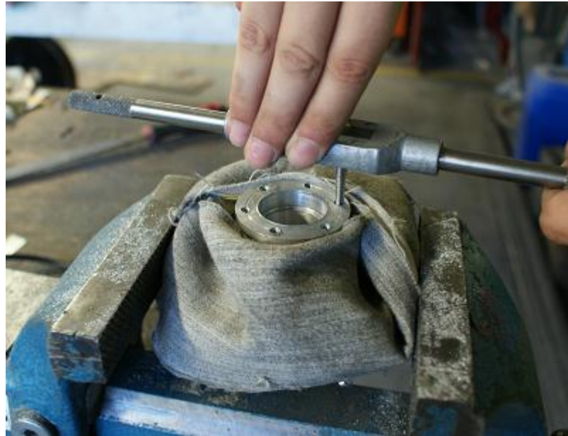
Figura 8.4 - Construção das roscas
