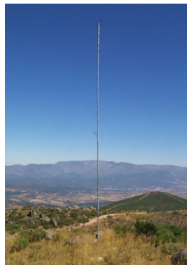
Figura 7.7 representação do mastro anemométrico da Gardunha [I14].
