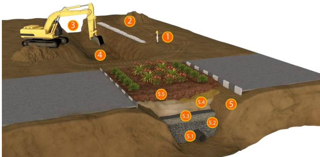
Figura 2.12 - Valeta com vegetação para águas pluviais ( http://www.aneam.org.br/index.php/noticias/assuntos-t%C3%A9cnicos/item/3583-valetas-com-cobertura-vegetal-promovem-a-filtragem-da-%C3%A1gua-da-chuva-e-retardam-seu-escoamento , 2014)
