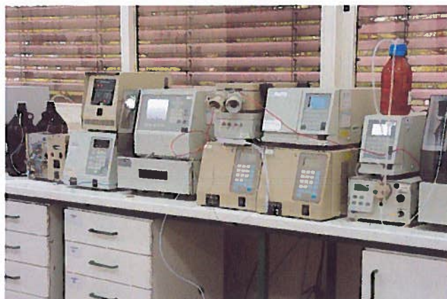
Figura 3.1: Sistema de cromatografia líquida de alta eficiência utilizado para a determinação de bromatos.
