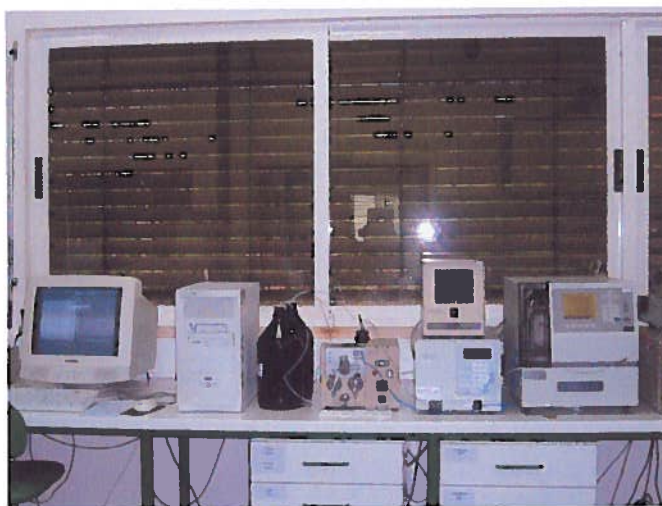
Figura 3.2: Sistema de cromatografia iônica utilizado para a determinação de bromatos (para comparação de métodos).
