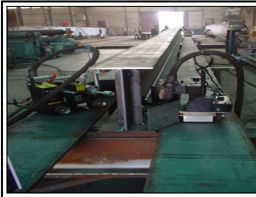
Figura 4.16 – Carros eléctricos de soldadura.
