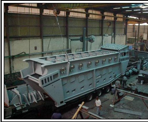
Figura 4.18 – Grelha de combustão para central de incineração.
