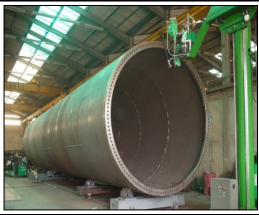
Figura 4.19 – Troço para torre eólica.
