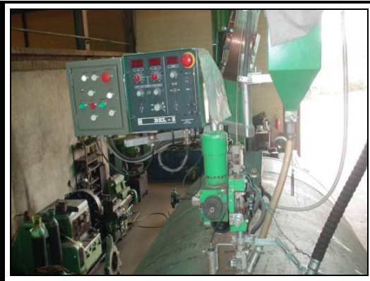
Figura 4.17 – Soldadura por arco submerso.
