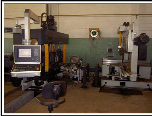
Figura 4.8 – Máquina de corte e furação de perfis FICEP DZB903.
