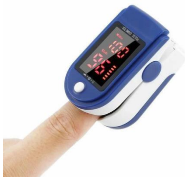
Figura 17 - Oxímetro de Dedo - Dispositivo utilizado para medir a saturação de oxigênio no sangue (SpO2) e a frequência cardíaca (bpm) dos participantes durante o estudo.
