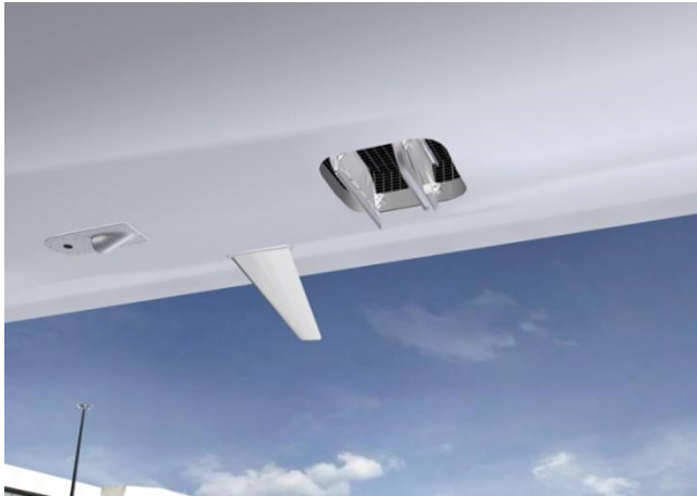
Figura 6 - Válvula de Saída (Outflow Valve): Componente essencial para o controle da pressão e fluxo de ar em sistemas aeronáuticos
