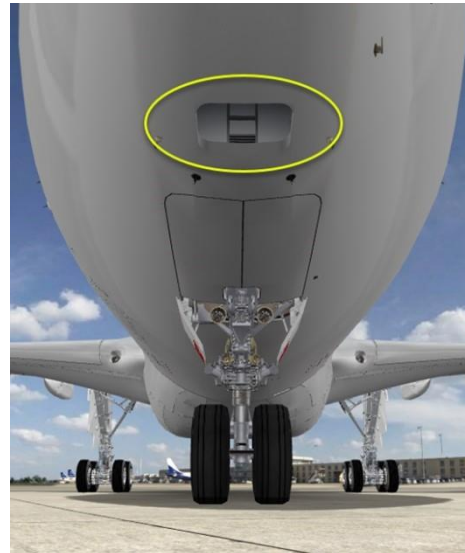
Figura 6 - Válvula de Saída (Outflow Valve): Componente essencial para o controle da pressão e fluxo de ar em sistemas aeronáuticos
