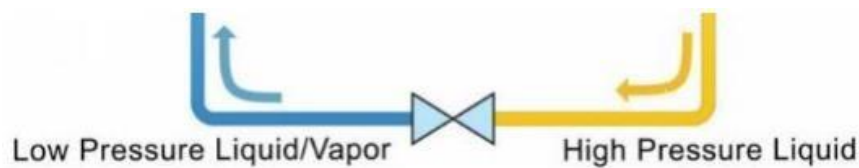
Figura 12: Estado do fluido entre os dispositivos de expansão. Fonte: (Lopes, 2019).
