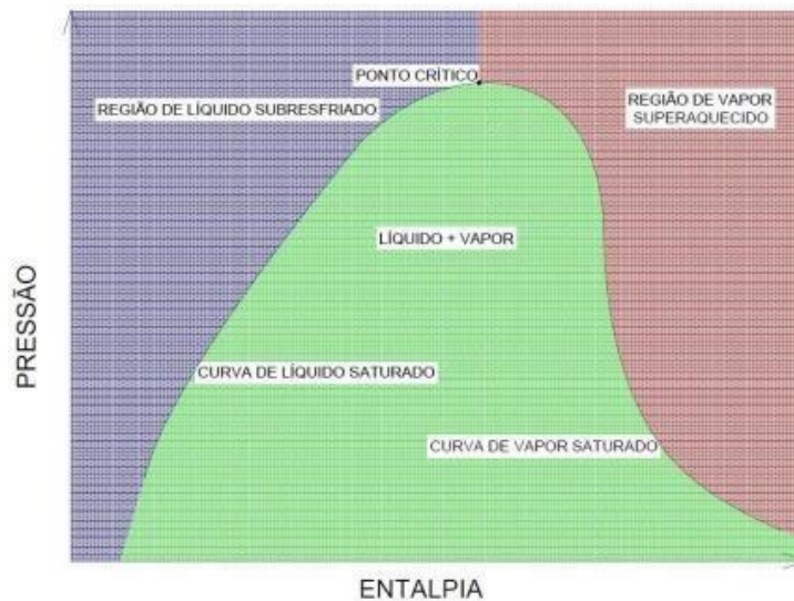
Figura 7: Diagrama de pressão e entalpia ( P-h ) (Ferreira,2016).
