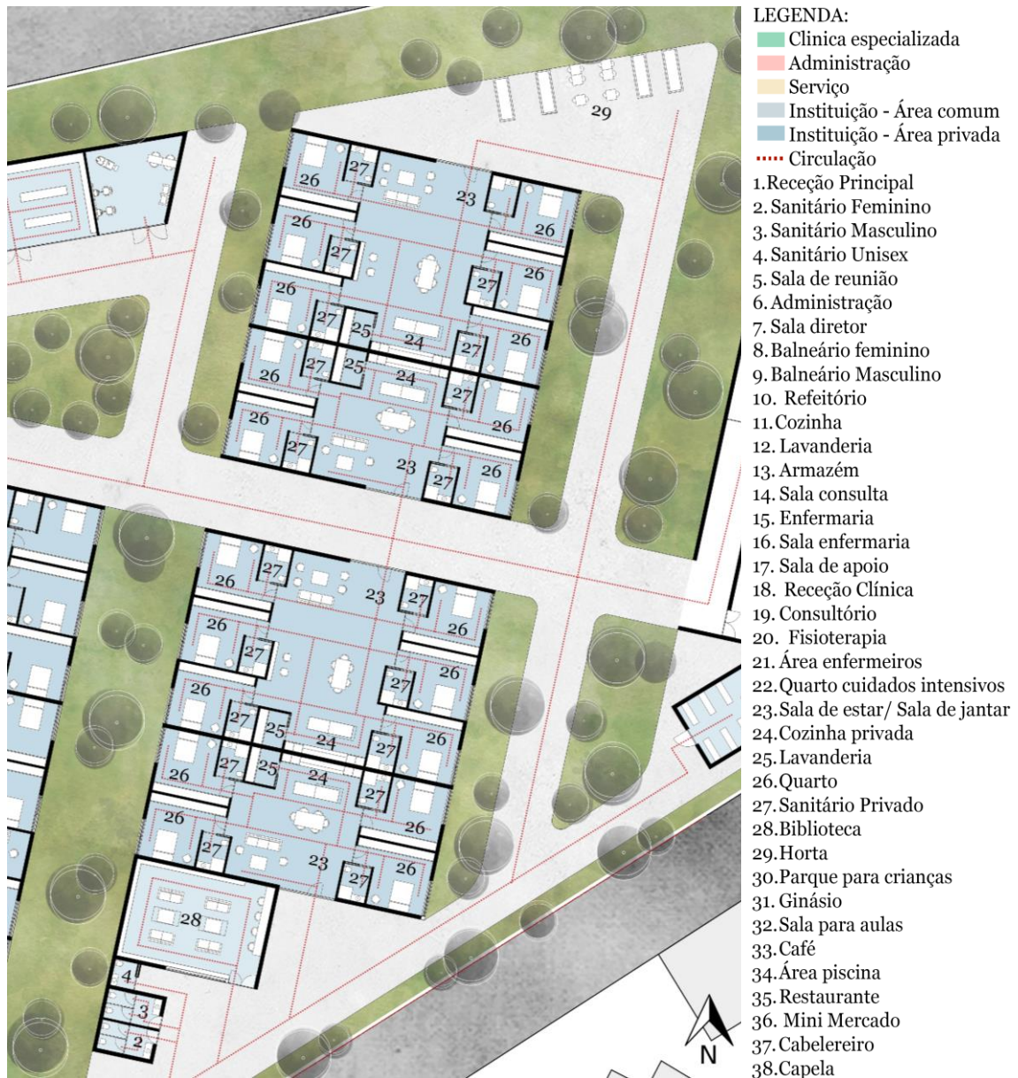
Figura 52 – Planta com setorização e circulação – edifício 1 e 2
