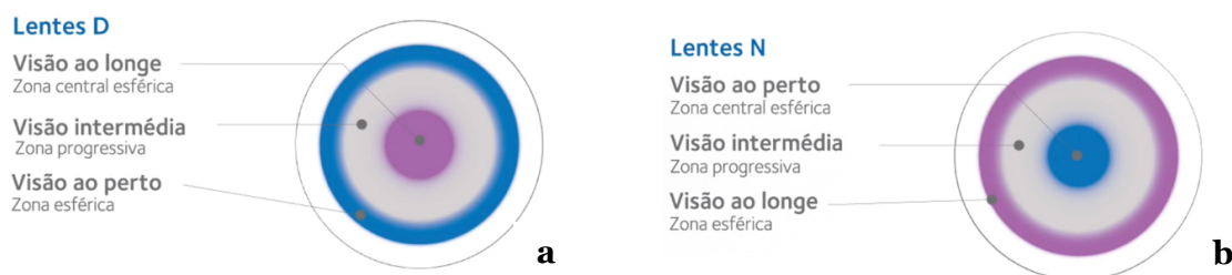
Figura 10: Desenhos de geometrias D (a) e N (b). Na figura 10 a) está representada uma geometria de centro-longe, privilegiando a visão de longe. Na figura 10 b) está representada uma geometria de centro-perto, privilegiando a visão próxima. (14)
