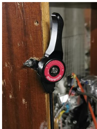
Figura 28- Montagem do cabo de acelerador
