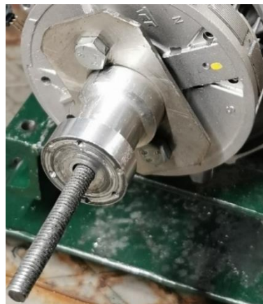
Figura 25- Montagem do adaptador da hélice
