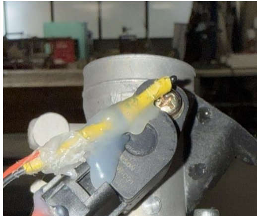
Figura 34- Montagem do termistor IAT
