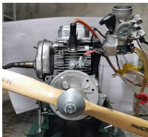
Figura 41- Montagem do sistema completo (EFI+EI) no motor
