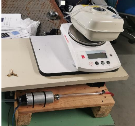
Figura 32- Montagem da bomba de combustível
