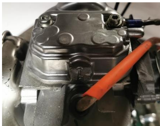
Figura 35- Montagem do termistor do bloco
