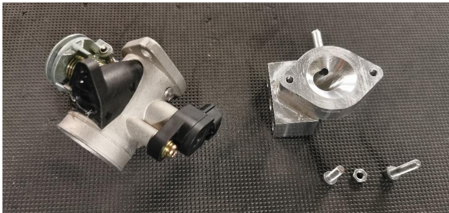
Figura 29- Montagem do corpo de acelerador e do limitador de fluxo
