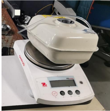
Figura 27- Montagem da balança e do tanque
