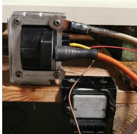
Figura 39- Montagem da bobina e módulo de ignição
