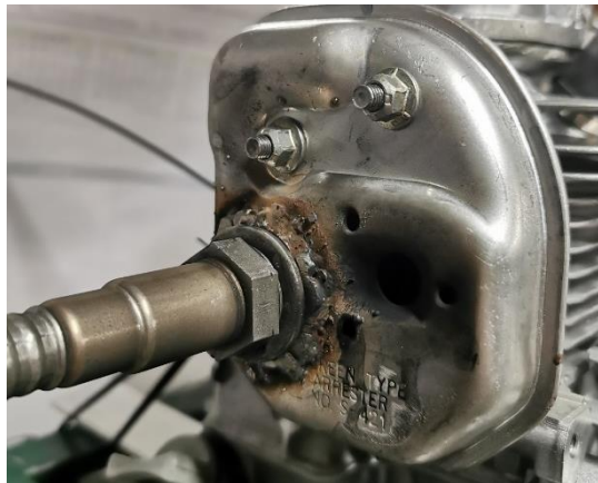
Figura 36- Montagem da sonda lambda
