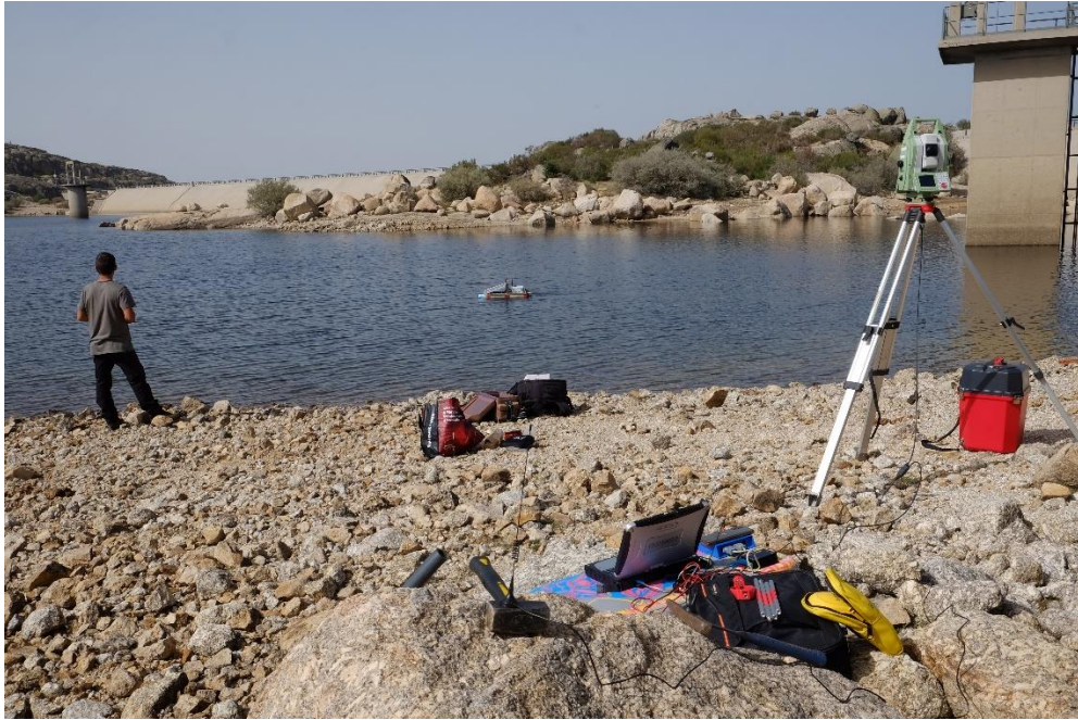
Figura 69: Equipamento em operação com medição contínua com recurso a estação total
