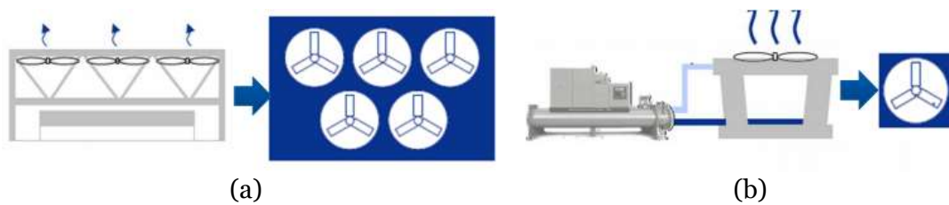
Figura 31 – Comparação de (a) sistemas de refrigeração a condensação a ar e (b) a água [97].
