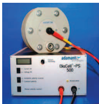
Figura 3.3: Célula electroquímica utilizada nos ensaios da instalação piloto.
