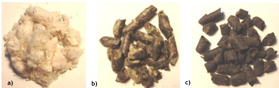
Figura 2.14 - Exemplos de fibras granulares celulósicas a) Arbocel, b) Viatop® AD10 e c) Viatop® 66 (Fonte: Martinho et al. , 2013)
