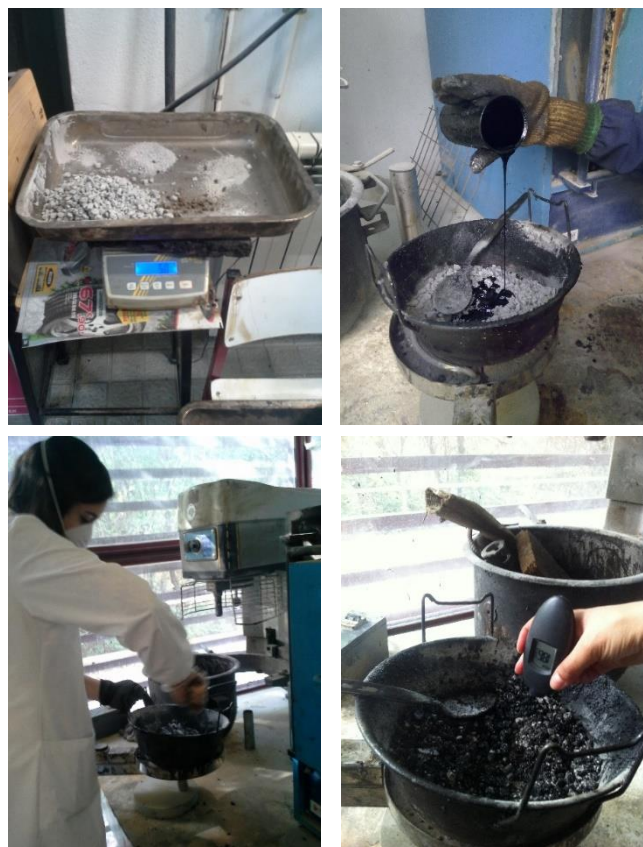
Figura 4.15 - Produção de mistura betuminosa drenante a quente
