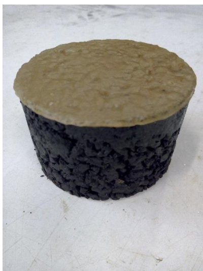
Figura 4.36 - Provete com face inferior parafinada
