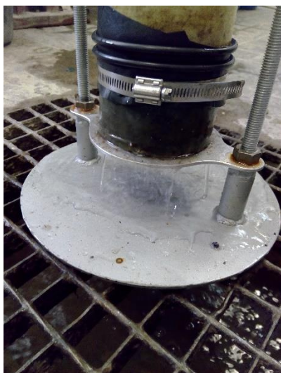
Figura 4.35- Ensaio de permeabilidade vertical
