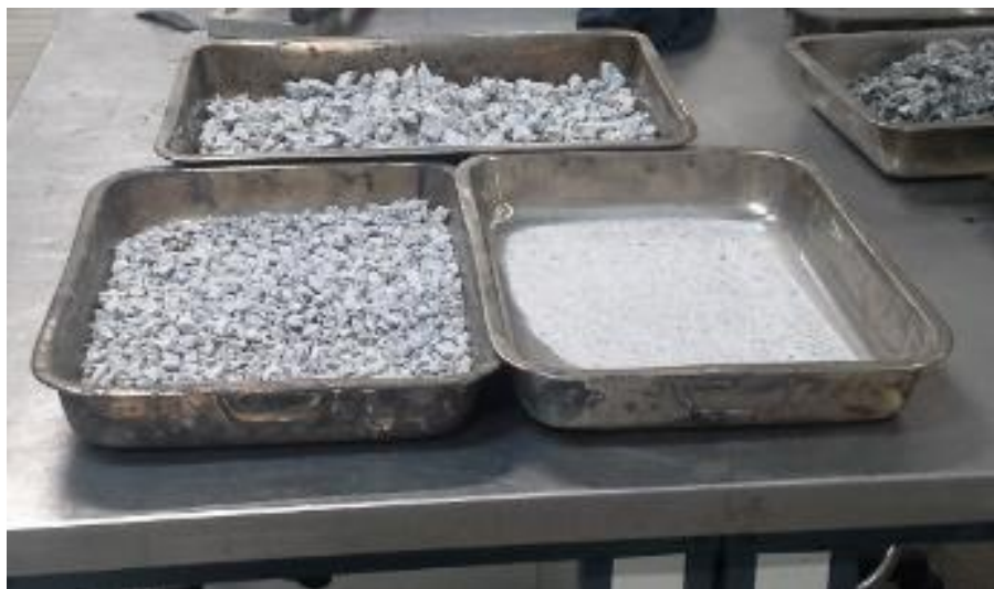
Figura 4.4 - Agregados a ser peneirados
