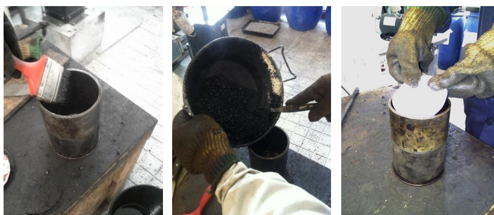
Figura 4.16 - Moldagem da mistura betuminosa drenante
