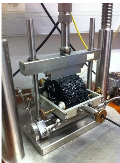
Figura 4.30 - Ensaio de tração indireta em compressão diametral no NAT (DECA-UBI)
