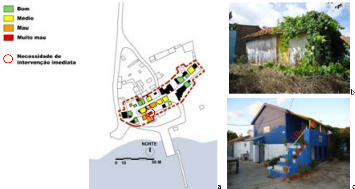
Figura 224 - (a) Palhota: (b) casa térrea em pior (n.º 3) e (c) palafita em melhor (n.º 12) estado de conservação.
