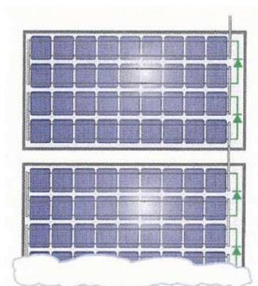
Fig. 26 - Disposição de módulos PV em caso de neve (posição horizontal) [40].
