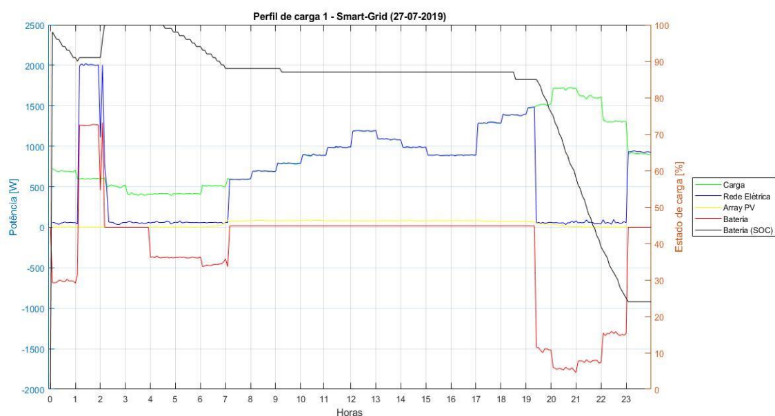
Fig. 62 - Modo de funcionamento Smart-grid - Perfil de carga 1.
