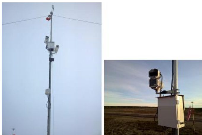
Fig. 19. Implementação do LiDAR num poste de visibilidade no aeroporto de Sodankylä, Lapônia (Matti Kutila et al. , 2016).
