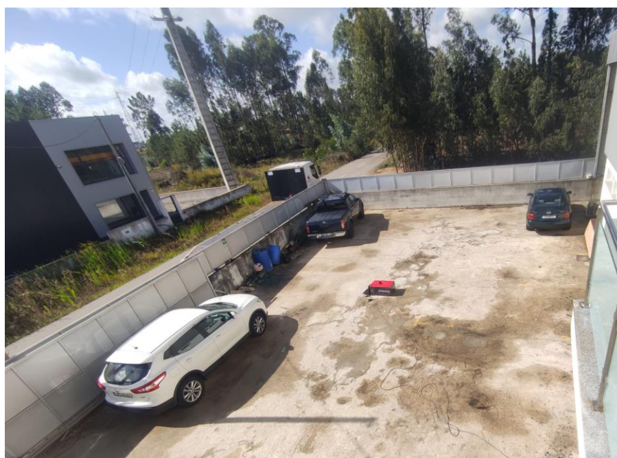
Fig. 37. Disposição do ambiente de testes outdoor em contexto real, equipamento LiDAR junto do computador no centro da imagem, viaturas distribuídas aleatoriamente, possível identificação dos muros envolventes.
