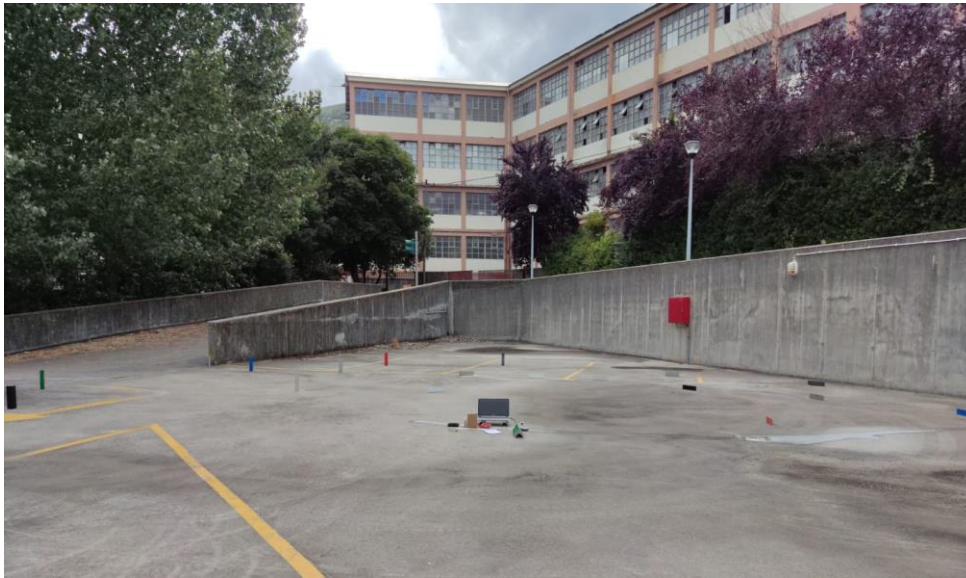
Fig. 35. Disposição do ambiente de testes outdoor , equipamento LiDAR junto do computador no centro da imagem, chapas metálicas distribuídas aleatoriamente, possível identificação dos muros envolventes.
