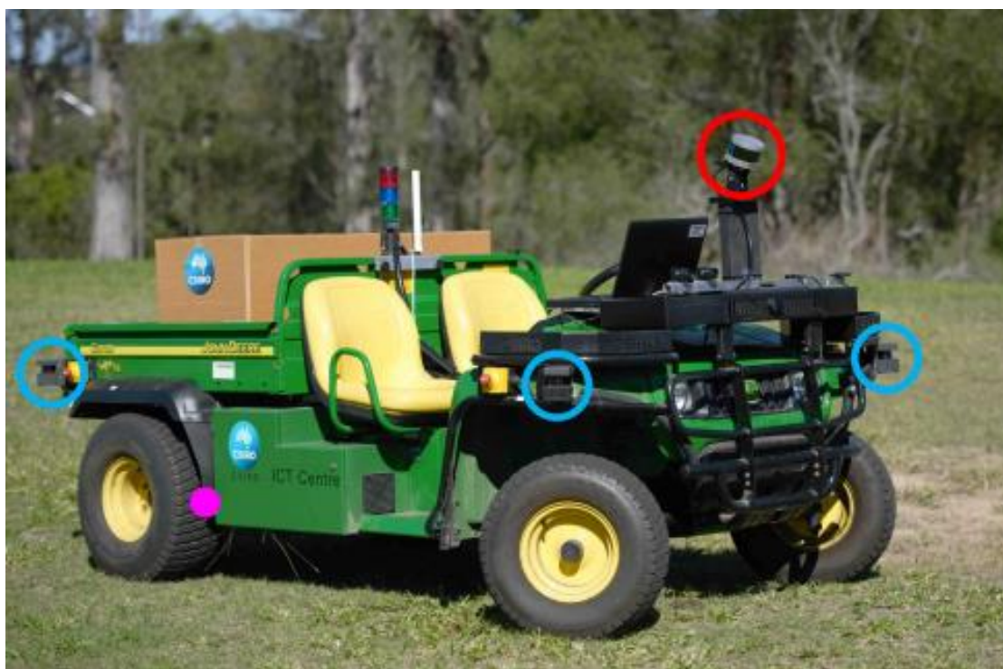
Fig. 17. Veículo elétrico de tamanho real, John Deere TE Gator, equipado com Velodyne PUCK 3D LiDAR, assinalado a vermelho (Andreas Pfrunder et al. , 2017).
