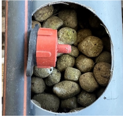
Figura 8 - Interior de um tubo com leca como matriz de suporte.
