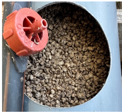
Figura 9 - Interior de um tubo com caroço de azeitona como matriz de suporte.
