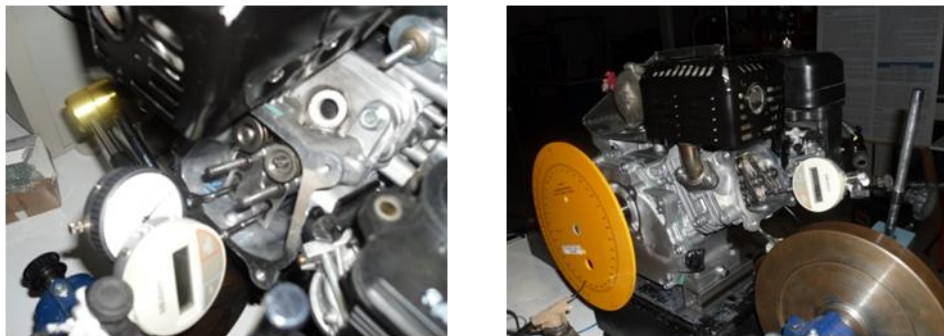
Figura 4.2 - Fotografias da montagem e da medição do deslocamento das válvulas.
