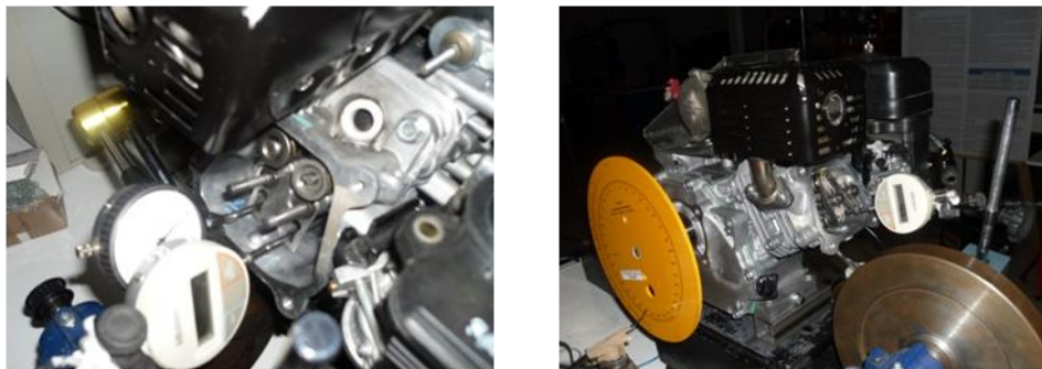
Figura A2.1 - Fotografias da montagem e da medição do deslocamento das válvulas.
