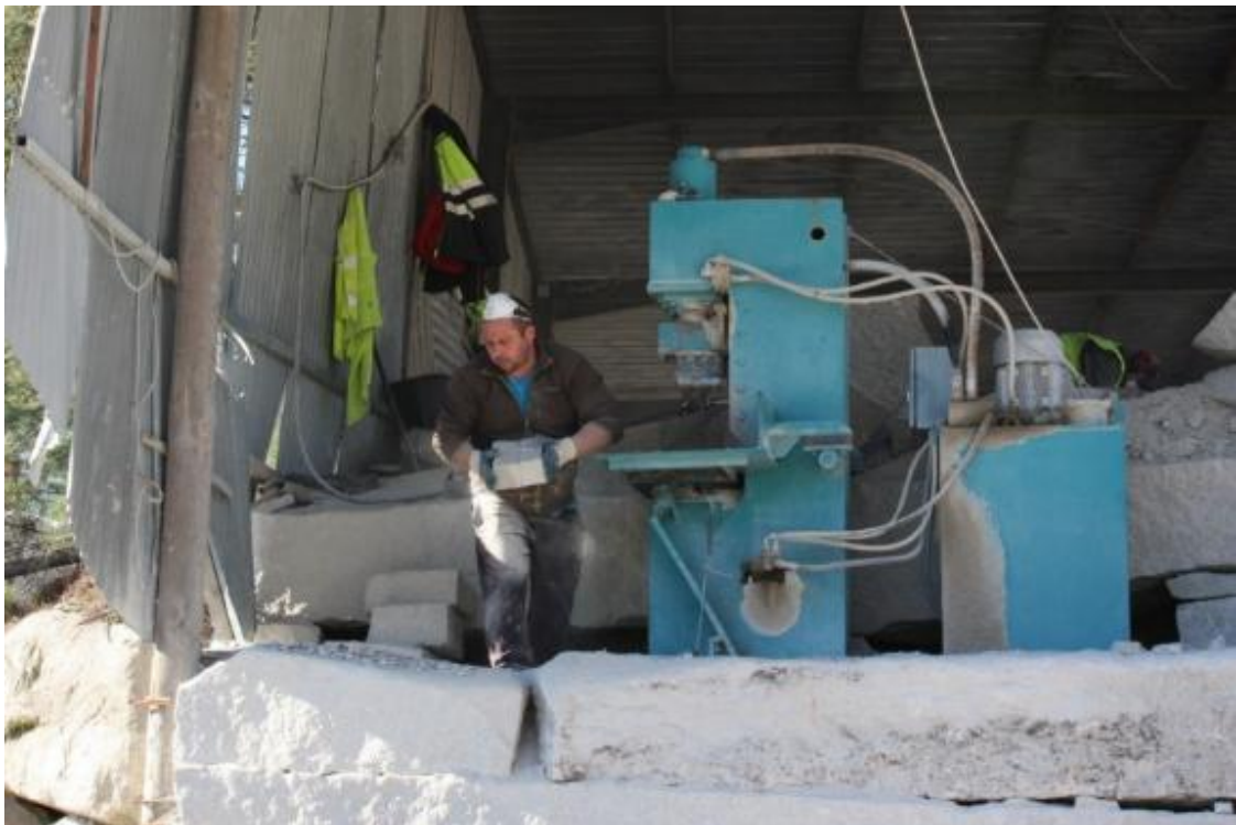
Figura 85| Transformação de desperdícios em cubos para calçada (Autora, 2024)
