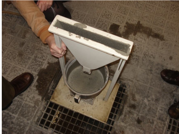
Figura 3.15 - escoamento da argamassa no Funil-V
