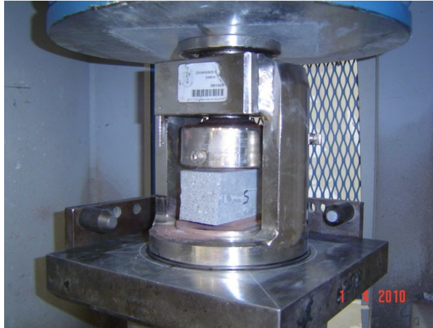
Figura 3.17 - Adaptador utilizado na prensa para os ensaios em argamassas
