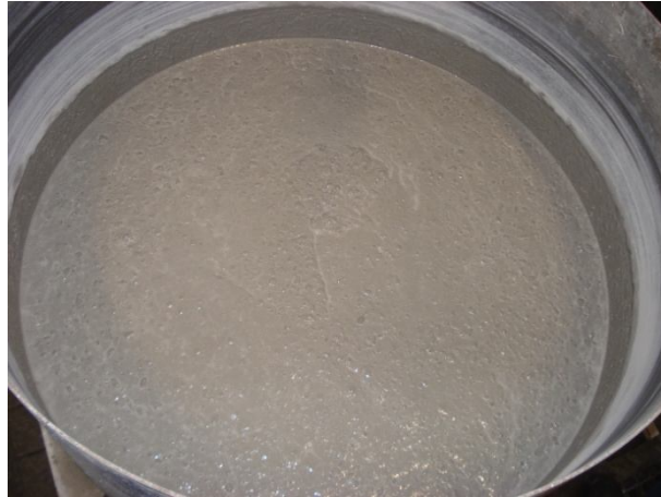
Figura 3.26 - Aspecto geral do betão após a amassadura
