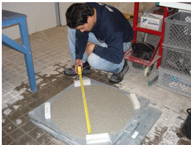
Figura 3.29 - Medição do diâmetro da argamassa segundo uma direcção
