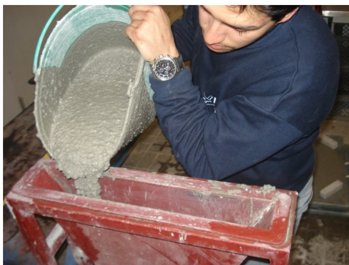
Figura 3.31 - Enchimento do Funil-V
