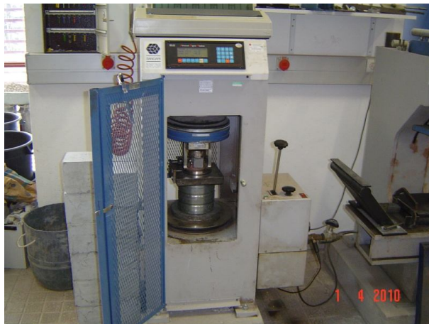
Figura 3.16 - Prensa utilizada no ensaio de compressão dos provetes
