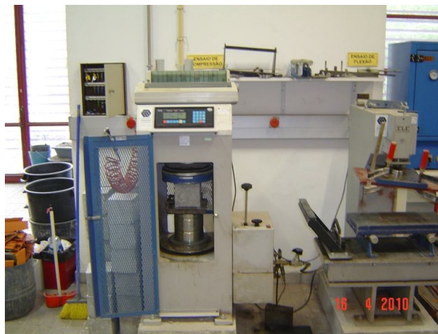
Figura 3.38 - Prensa utilizada no ensaio de compressão dos provetes
