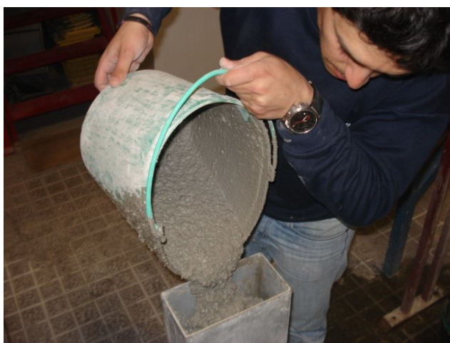
Figura 3.32 - Enchimento da Caixa-L com betão
