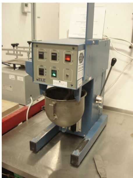
Figura 3.9 - Misturadora utilizada na produção das argamassas
