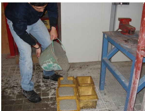
Figura 3.36 - Enchimento dos moldes com betão
