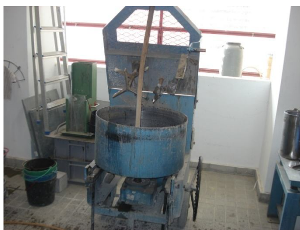
Figura 3.25 - Betoneira misturadora utilizada na produção dos betões
