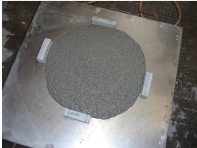
Figura 3.28 - Betão espalhado sobre a superfície lisa
