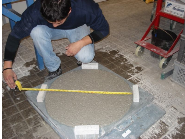
Figura 3.30 - Medição do diâmetro da argamassa segundo a direcção perpendicular
