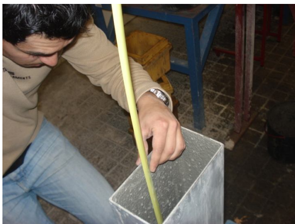
Figura 3.35 - Medição do parâmetro H2 na Caixa-L
