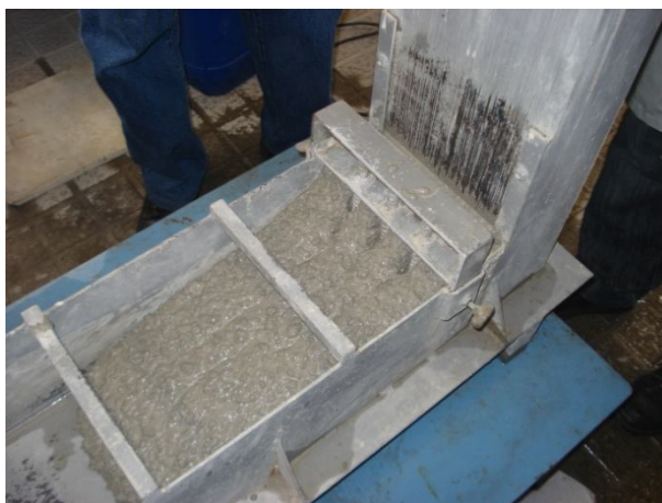
Figura 3.33 - Passagem do betão pelo obstáculo na caixa-L
