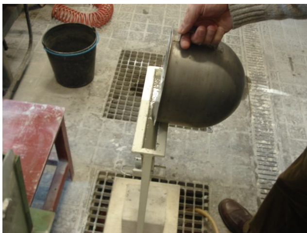
Figura 3.14 - Enchimento do Funil-V com argamassa
