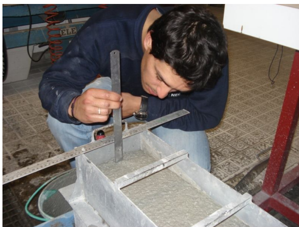
Figura 3.34 - Medição do parâmetro H1 na Caixa-L
