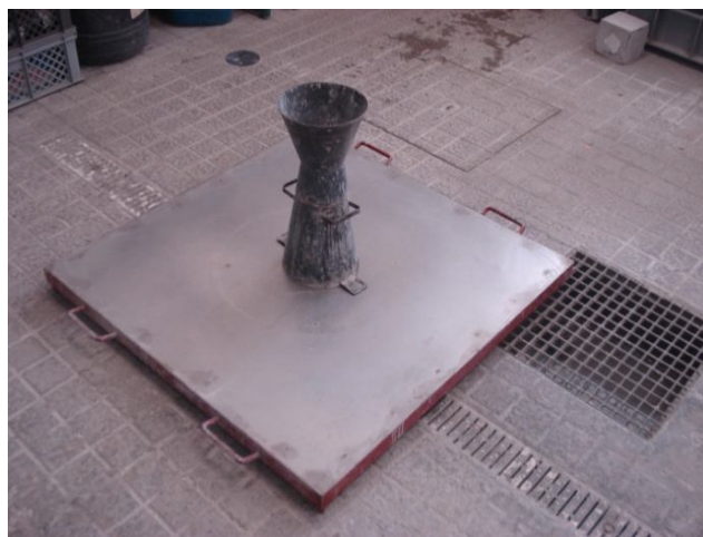
Figura 3.27 - Cone de espalhamento sobre superfície lisa
