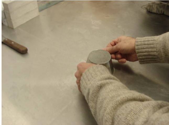
Figura 3.11 - Cone de espalhamento já preenchido de argamassa
