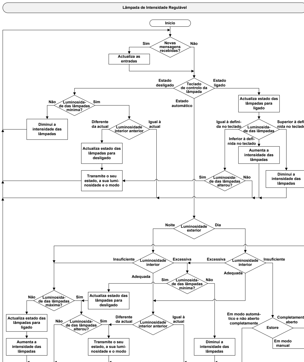
Fig. 6.14. Diagrama de fluxo da aplicação de teste da lâmpada de intensidade regulável.
