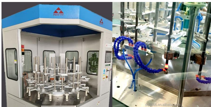
Figura 2.3 Exemplo de máquina de brasagem automatizada, à esquerda, da empresa DQAUTO e à direita o modo de funcionamento da brasagem por indução (retirado de [24]).
