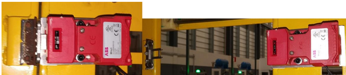
Figura 3.22 - À esquerda o sensor está fechado e à direita o sensor está aberto.
