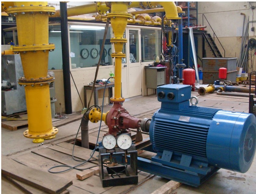
Figura 5.1.1.: Instalação experimental da empresa Efaflu - Bombas e Ventiladores S.A. As medições típicas são o caudal e a pressão manométrica na entrada e saída da bomba.
