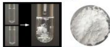
Fig. 7 – Obtenção de pigmentos sintéticos por co-precipitação.
