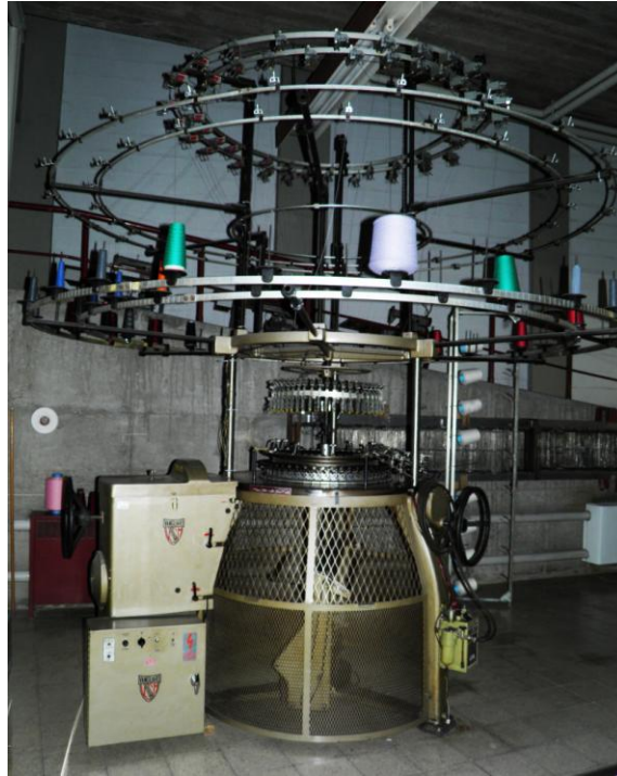
Figura 28 - Tear de Malha Circular Vanguard Supreme Fonte: Autoria própria
