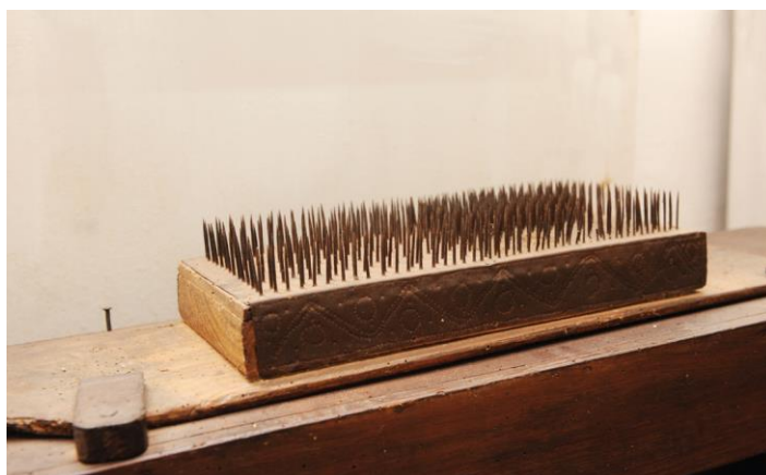
Figura 12: Sedeiro: ferramenta utilizada na assedagem do linho.
