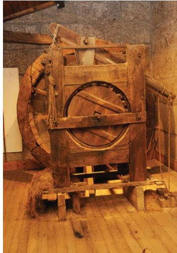
Figura 10: Engenho de tracção hidráulica utilizado na maçagem do linho.
